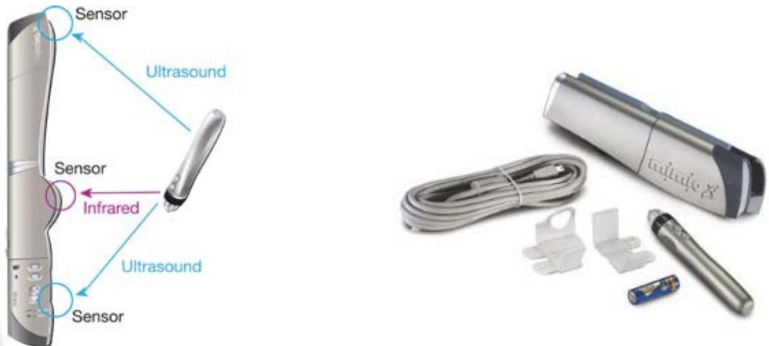
Mediante un sistema de triangulación, Mimio es capaz de capturar todos los trazos que se realizan en la pizarra, así como la posición del cursor sobre la pizarra proyectada.
